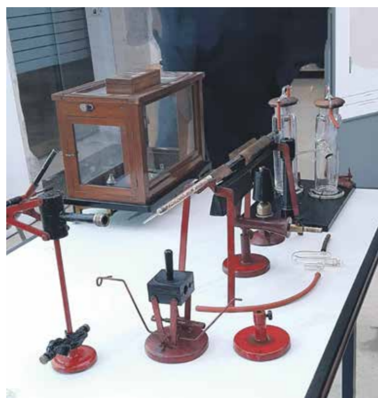
Preglova naprava za mikroanalizo FOTO JASNA KONTLER SALAMON
